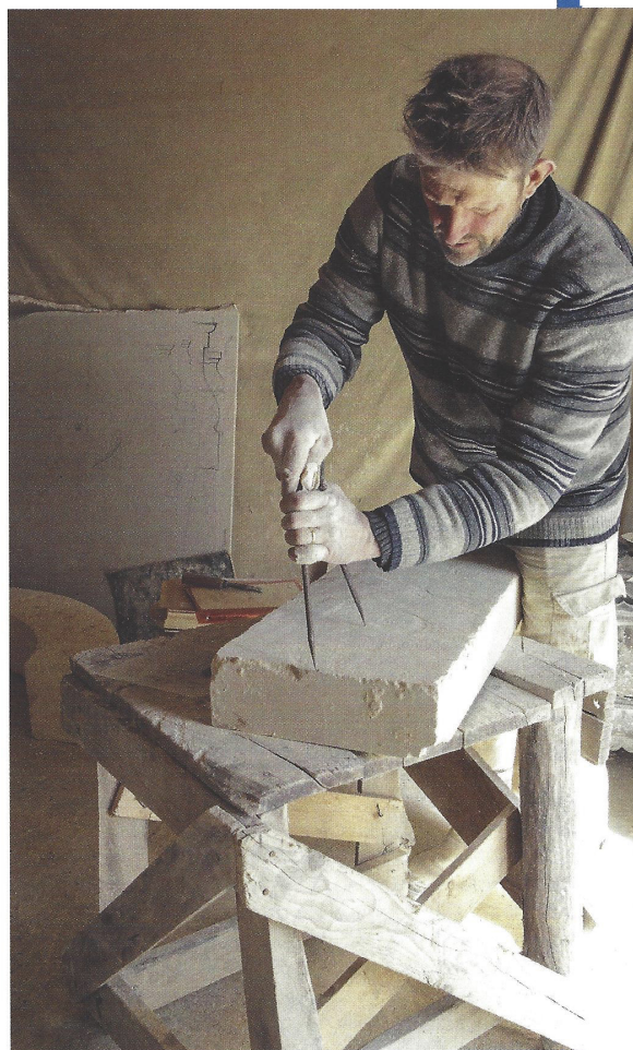
▲ Avec son compas, Philippe effectue des tracés géométriques précis sur le bloc de calcaire.
