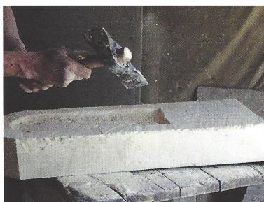
◀ À l'aide du ciseau à pierre et de la massette tronconique, l'artisan donne forme à la fontaine.
